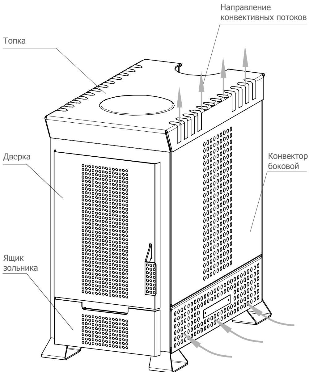
Рис. 1 Общий вид печи
