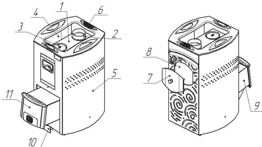
**Рисунок 1. Конструкция печи-каменки «ДОМНА»**
