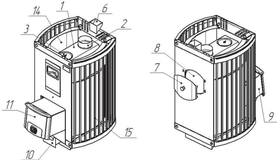
**Рисунок 3 Конструкция печи-каменки «ДОМНА-СЕТКА»**
