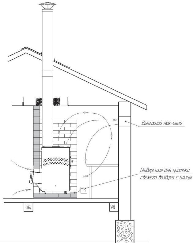
Рисунок 13. Схема воздухообмена в парилке
