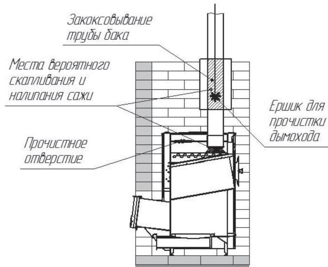
Рисунок 14. Схема прочистки печи
