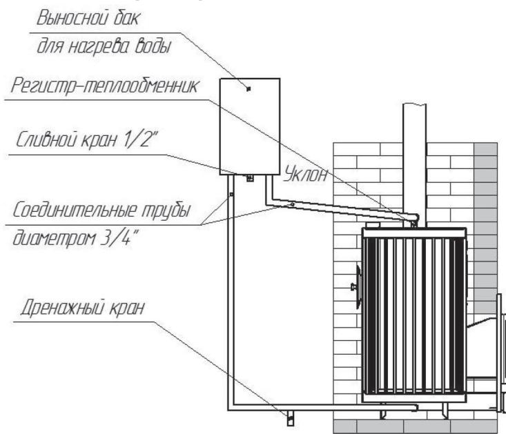
**Рисунок 8. Подключение бака с встроенным регистром**
