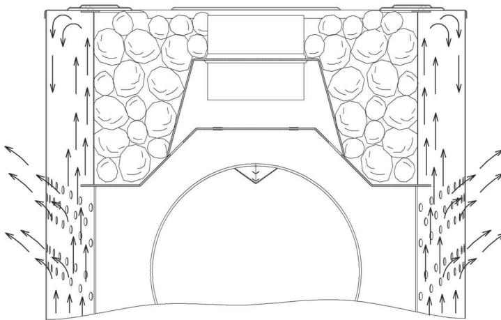
Рисунок 6 Конструкция и принцип действия термос-каменки
