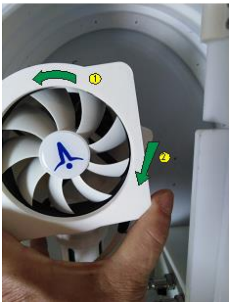
Рисунок 10: Зніміть вентиляторний блок із корпусом (утримується магнітами) та ретельно очистіть щіткою.
