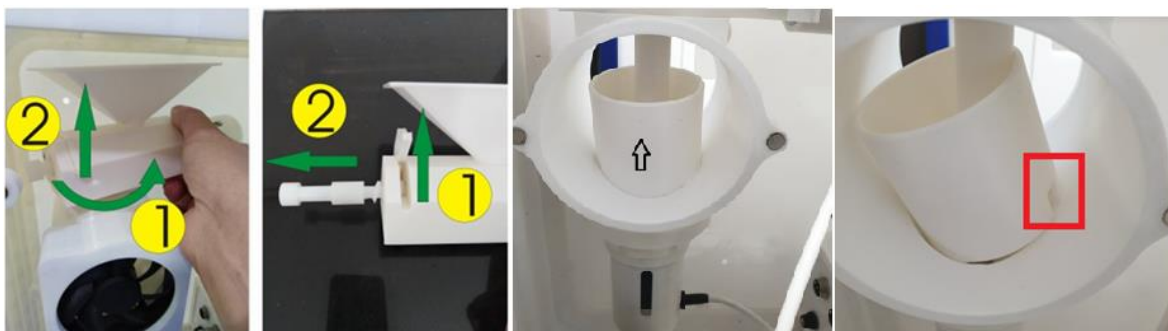
Рисунок 11. Зняття воронки та дозатора й очищення їх за допомогою щітки.
