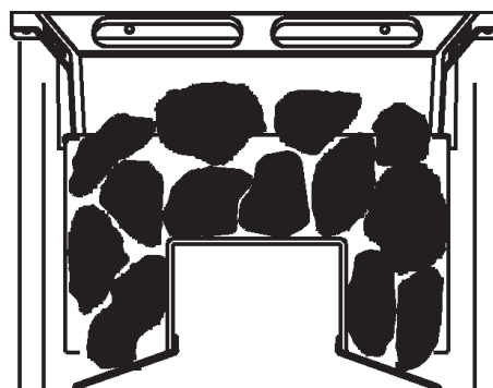
Bild 2.2. Placering av bastustenar Placera bastustenarna på plats så att det blir tillräckligt med luft mellan stenarna. Genomsärningsbild på bastuugns stenmagasin.
